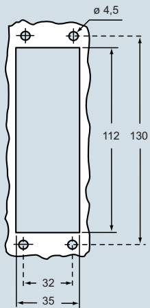
Montageausschnitt Anbaugeschäuse in mm
